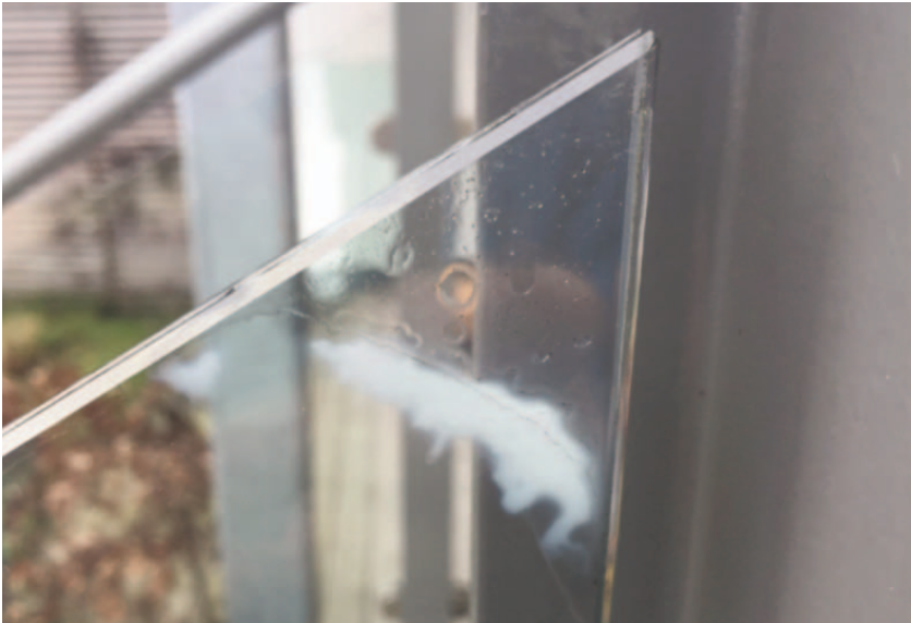
Billede 1: Eksempel på delaminering typisk for kritiske formater.
